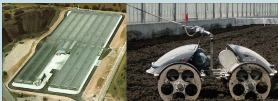
Photo 1 : Plus grande ligne de séchage solaire de boues au monde à Palma de Majorque Photo 2 : Sanglier électrique® retourneur des boues.
